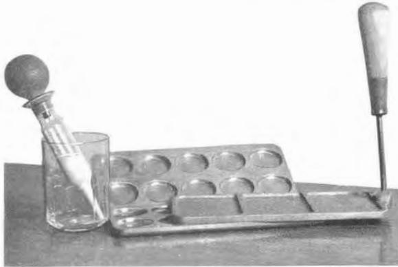
Abb. 28. Gefrierapparat von Dr. PAUL EMERSON (Boston U.S.A.). Die Milch wird mit der Pipette in die Höhlungen gefüllt. (Das Trockeneis wird unter und auf die Aluminiumplatten gelegt.)
