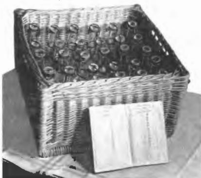
Abb. 14. Flaschenkorb für den Eisbehälter im Kraftwagen, davor Sammelbuch.
