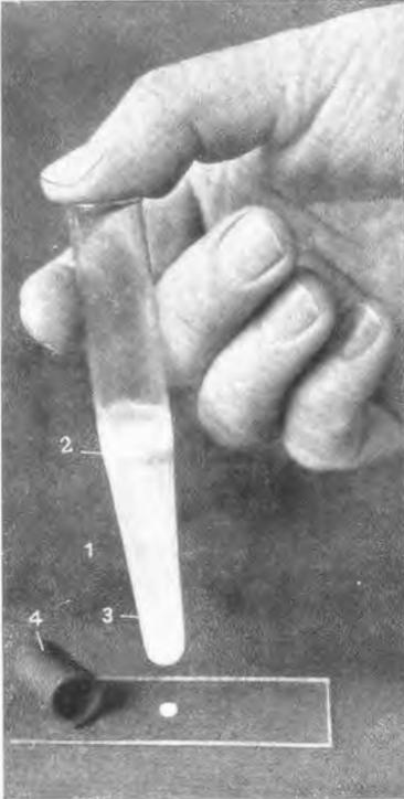
Abb. 18. Durchlochtetes Zentrifugenglas. 1 Zentrifugenglas. 2 Fettschicht. 3 Fettarme Milch. 4 Gummikalotte.
