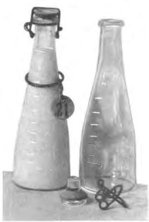
Abb. 9. Graduierte Flasche mit Nummer (kochecht). Abnehmbarer Stöpsel und abnehmbarer Drahtbügel.
